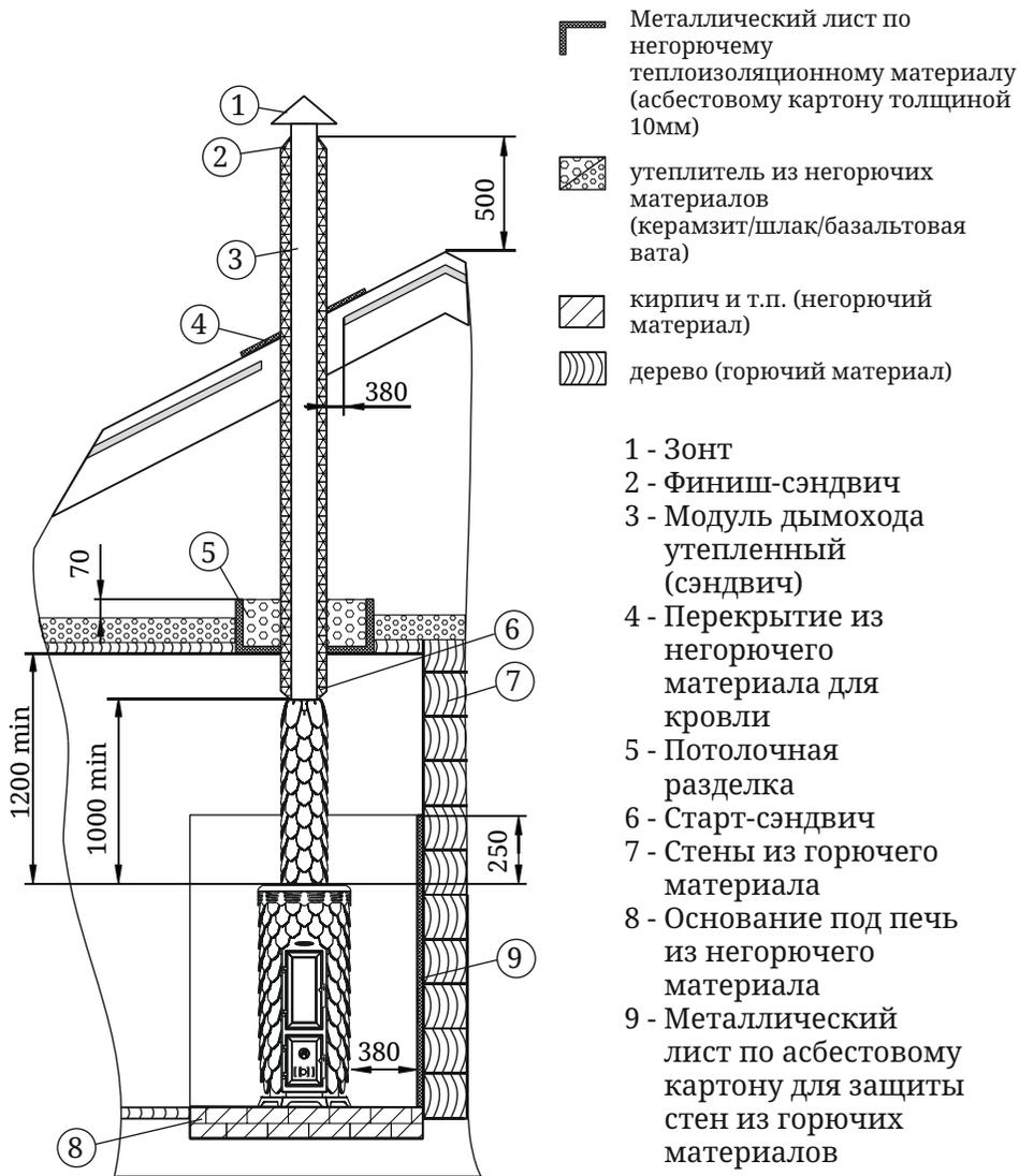
Рисунок 3. Пример монтажа печи «Сента Панголина» с присоединением к металлическому дымоходу
