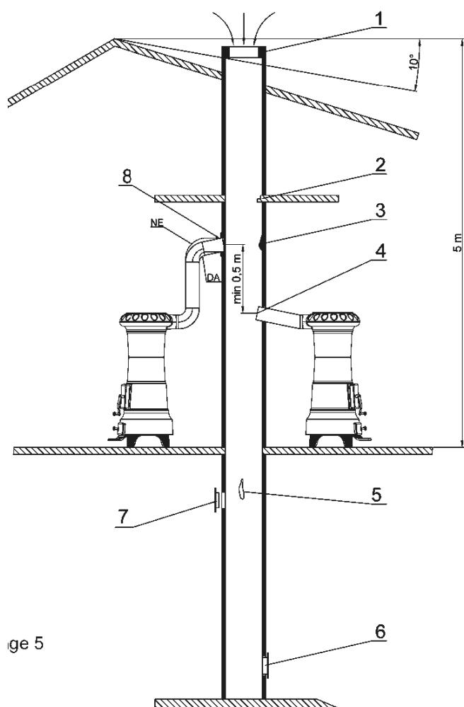
При наличии дымохода квадратного или прямоугольного сечения, его внутренние кромки следует закруглить. Слишком маленькое внутреннее сечение уменьшает вытяжную способность. Рекомендуемая минимальная высота составляет 4 м. Использование внутренних поверхностей из асбестоцемента, оцинкованной стали, а также грубых или пористых внутренних поверхностей недопустимо, поскольку они ухудшают работу дымохода.
